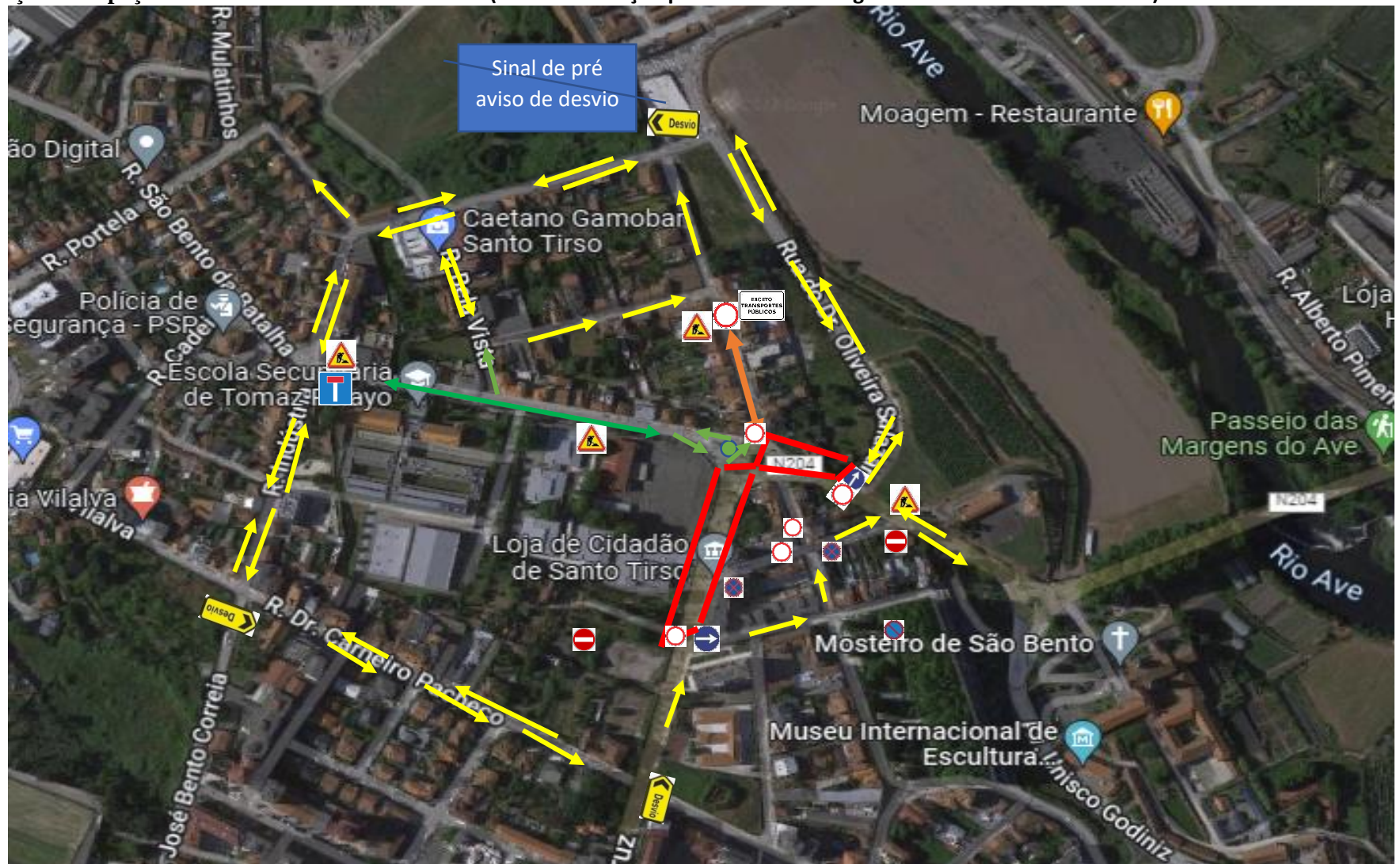
Esquema de colocação de sinalização /desvios Fase 1.- Revisão 4.6- Intervenção na Rotunda/ Intervenção na Rua Avenida de Sousa Cruz - Adaptação de Espaços Públicos de Santo Tirso ao PMUS (Data intervenção prevista de 30 de Agosto a 30 Novembro de 2022)
